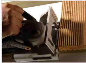
Usinage de la rainure
