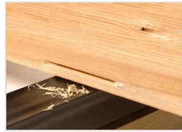
Lame fraisée (profondeur 13 mm)
