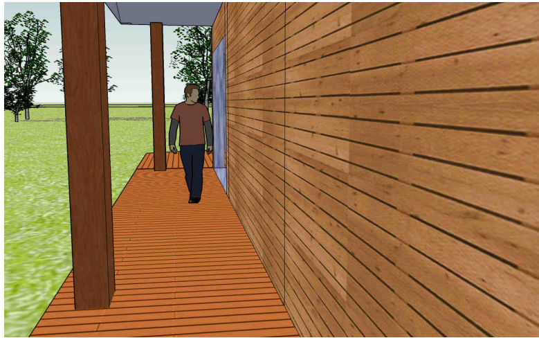
Cheminement avec les lames posées en travers
